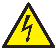
hoge elektrische spanning
